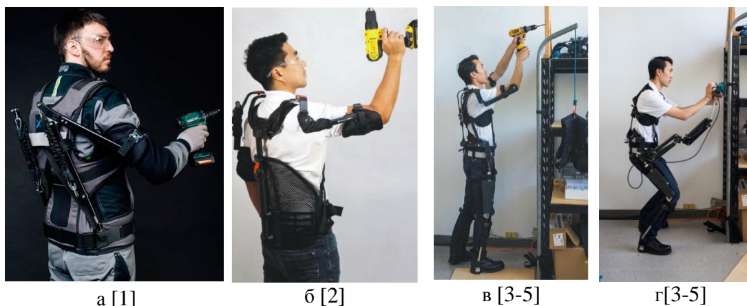
Рисунок 1. Ассистирующие устройства промышленного назначения: а и б - с распределением масс на спину («локальные»), в и г - с упором на землю («общие»).
