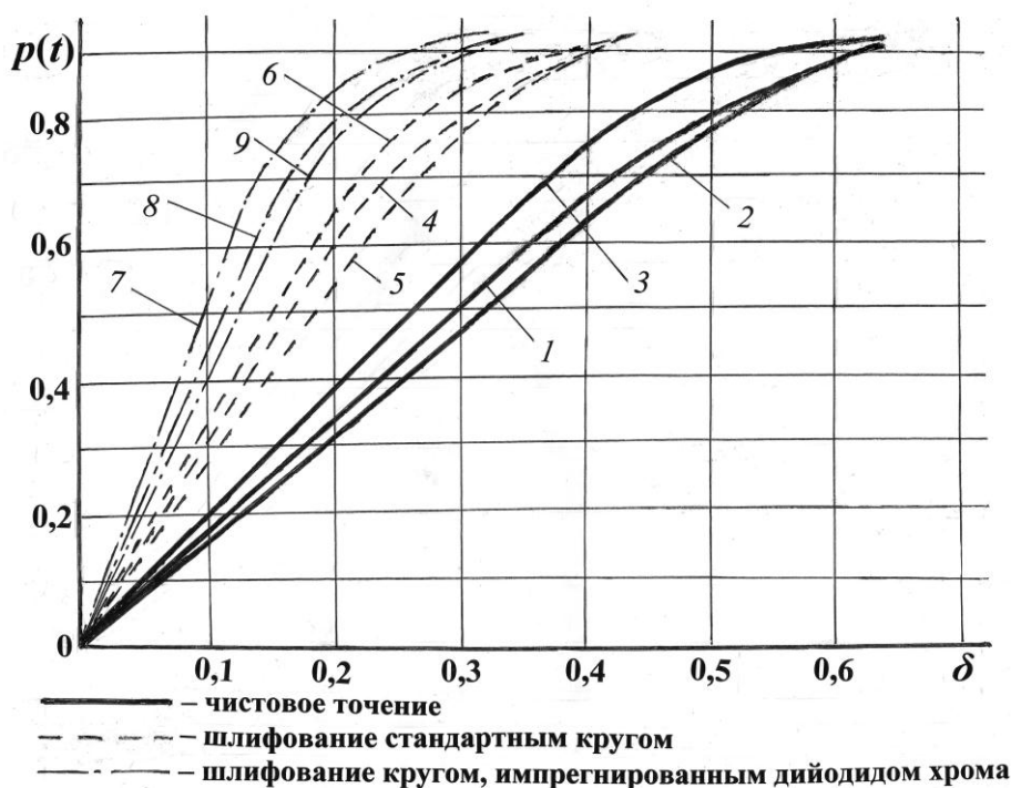
Рисунок 1. Зависимости вероятности технологического обеспечения надёжности p(t) параметров шероховатости Ra (кривые 1, 4, 7), R_{max} (кривые 2, 5, 8) и S_m (кривые 3, 6, 9) от величины относительного отклонения допусков на них \delta при чистовом точении и последующем шлифовании стандартным и импрегнированным кругом деталей из стали 12Х2Н4А
